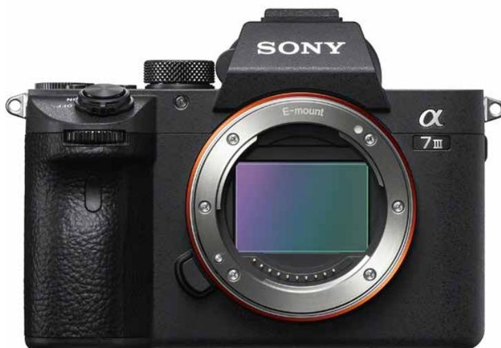
有効約 2420 万画素の 35mm フルサイズ裏面照射型 CMOS イメージセンサー「Exmor R」を搭載したミラーレスデジタル一眼カメラ。高精度な手ブレ補正ユニットとジャイロセンサーを備える。手ブレ補正アルゴリズムも最適化したことで、5.0 段の補正効果を実現。独自の AF システム「4D フォーカス」に対応。
